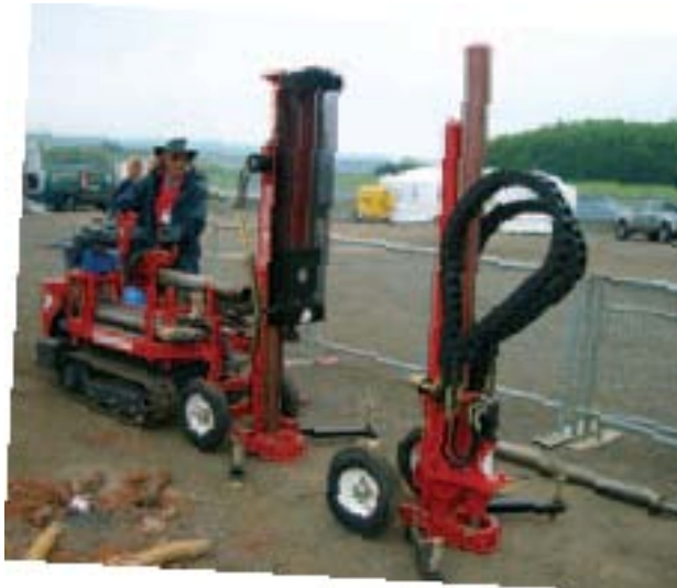
Mini Bohrgerät zum setzen von Leitpfosten
